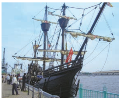
全長25.9m、最大幅6.72m、排水量170t。当時と同じ材質と大きさです。
